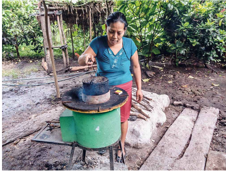
Des fourneaux de cuisine adaptés permettent d'économiser le bois et le charbon.
